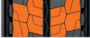
Les larges pains de gomme de la bande de roulement renforcent la rigidité et améliorent le rendement kilométrique tout en bénéficiant d'une faible résistance au roulement.
