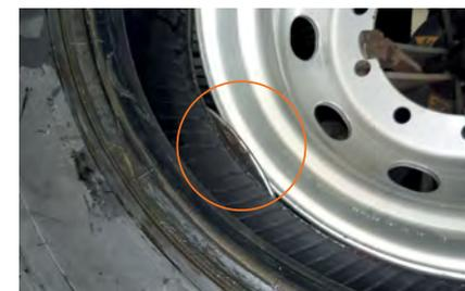
10 Positionnez le disque détalonneur entre la bride de jante et le talon du pneumatique. Dans ce cas, le disque ne doit pas toucher la roue.
