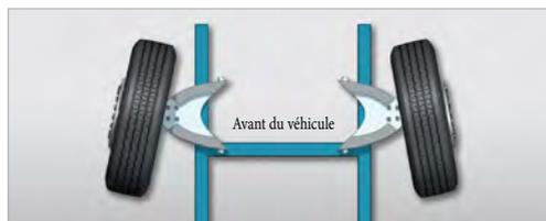
Le pincement fait référence à des roues d'un véhicule qui sont inclinées de telle sorte que les deux roues avant (vues de l'avant comme le montre l'illustration de gauche) sont plus rapprochées à l'avant qu'à l'arrière des roues.
