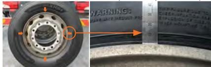
► Mesurez la distance de la « Bride de jante ~ Ligne de contrôle de la jante », en 4 points (intérieur/extérieur).
