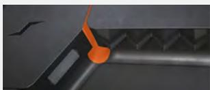
Elles apparaissent au fur et à mesure que le pneu s'use. Grâce à elles, le pneu possède une plus grande surface de contact au sol donc une meilleure adhérence et motricité.
