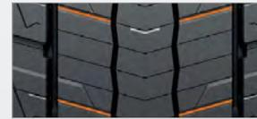
Au fur et à mesure que le pneumatique s'use, les lamelles et les rainures apparaissent pour apporter de meilleures performances de traction et d'adhérence sur sol mouillé.
