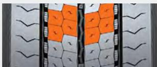
Les larges pains de gomme de la bande de roulement améliorent la rigidité du bloc sommet et donc le kilométrage, tout en assurant une faible résistance au roulement.
