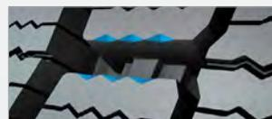
Les bord des blocs en dents de scie apportent une adhérence maximale sur sols enneigés et verglacés ainsi qu'une réduction de la distance de freinage en hiver.
