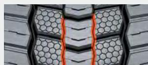
Les rainures en zig zag au centre contraignent le cisaillement des blocs pour une meilleure résistance au roulement.
