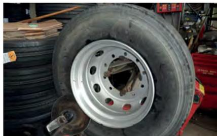
2 Fixez l'ensemble pneumatique-roue sur la machine automatique. Placez le disque détalonneur sur la base creuse en actionnant le bras de la machine.
