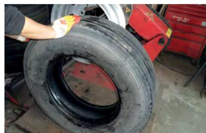
11 Effectuez une rotation dans le sens horaire et détalonnez complètement le pneumatique de la roue.
