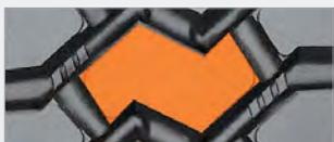
Les blocs massifs et un composé spécifique de la bande de roulement offrent une excellente résistance contre les coupures et les perforations.
