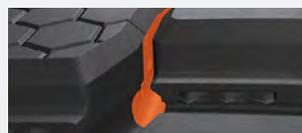
Elles apparaissent au fur et à mesure que le pneu s'use. Grâce à elles, le pneu possède une plus grande surface de contact au sol donc une meilleure adhérence et motricité.
