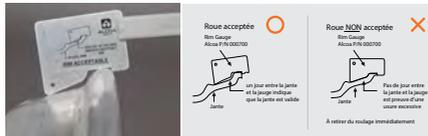
► Vérifiez la déformation de l'ensemble de la bride de jante en utilisant la jauge de bride de jante pour décider d'utiliser ou non ce pneumatique.
