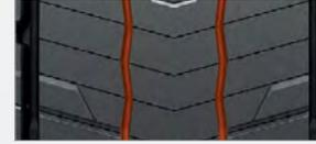
Les rainures en zig zag au centre contraignent le cisaillement des blocs pour une meilleure résistance au roulement.
