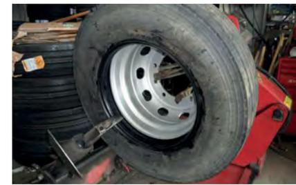
8 Décollez l'ensemble du talon (côté extérieur et côté opérateur) de la roue.
