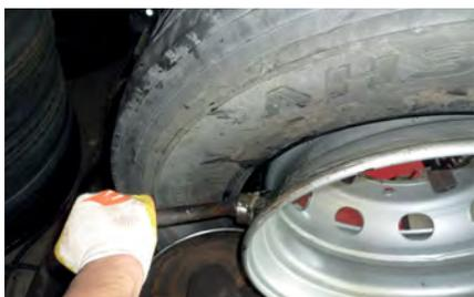
3 Après avoir créé un espace entre le pneumatique et la roue à l'aide du disque détalonneur, appliquez la pâte de montage sur la bride de la jante et le talon du pneumatique pour éviter d'endommager ce dernier.
