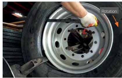
7 Positionnez le levier entre la bride de la roue et le talon de pneumatique puis faites-le tourner dans le sens horaire.
