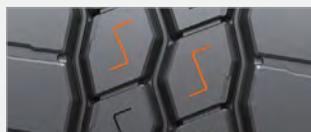
3 rainures en zigzag et une sculpture avec une importante répartition de lamelles offrent des performances de traction et de freinage idéales tout en réduisant le risque d'arrachements.
