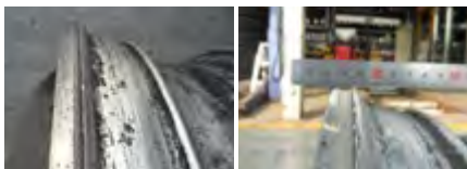
<Bride de jante déformée/usée avec bords tranchants>
