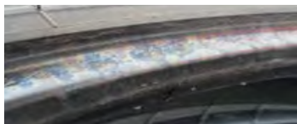
<Nombreuses craquelures sur le talon>
