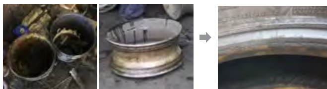
<Application d'une pâte de montage inadaptée>
