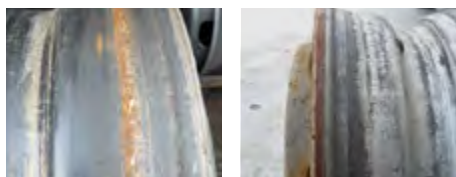
<Roue en acier corrodée>
