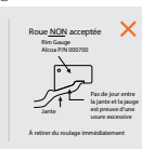
<Bride de jante déformée/usée avec bords tranchants>
