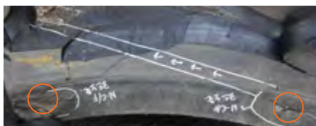
<Dommages lors des procédures de montage>
